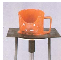
Thermoplaste schmelzen beim Erhitzen.
